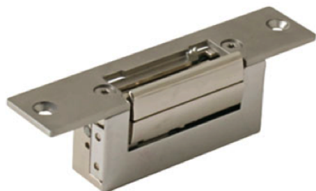
Codici: YS 134NO (S) * Dimensioni: L.110 x H.31,5 x sp.25mm Tenuta: 600 Kg
